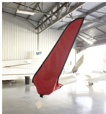
Schleicher ASH Wingtip Pads
